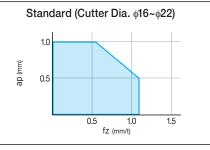
MFH16- $\cdots$ -2T, MFH17- $\cdots$ -2T, MFH18- $\cdots$ -2T MFH20- $\cdots$ -3T, MFH22- $\cdots$ -3T
